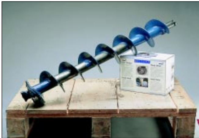
Povrstvenie šnekového dopravníka
