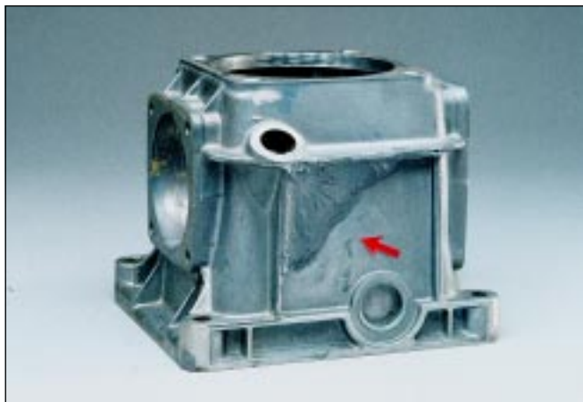
Oprava hliníkovej skrine
