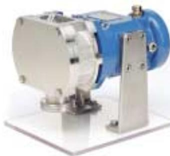
I modelli BE115, BE220, BE330 e BE440 sono realizzabili con la bocca d'aspirazione a sezione allargata rettangolare, per facilitare l'alimentazione della pompa con prodotti molto viscosi come impasti o miscele dense con pezzi semisolidi. In questi casi per agevolare l'ingresso del prodotto a caduta, la pompa viene installata con bocche verticali direttamente sotto la tramoggia.
