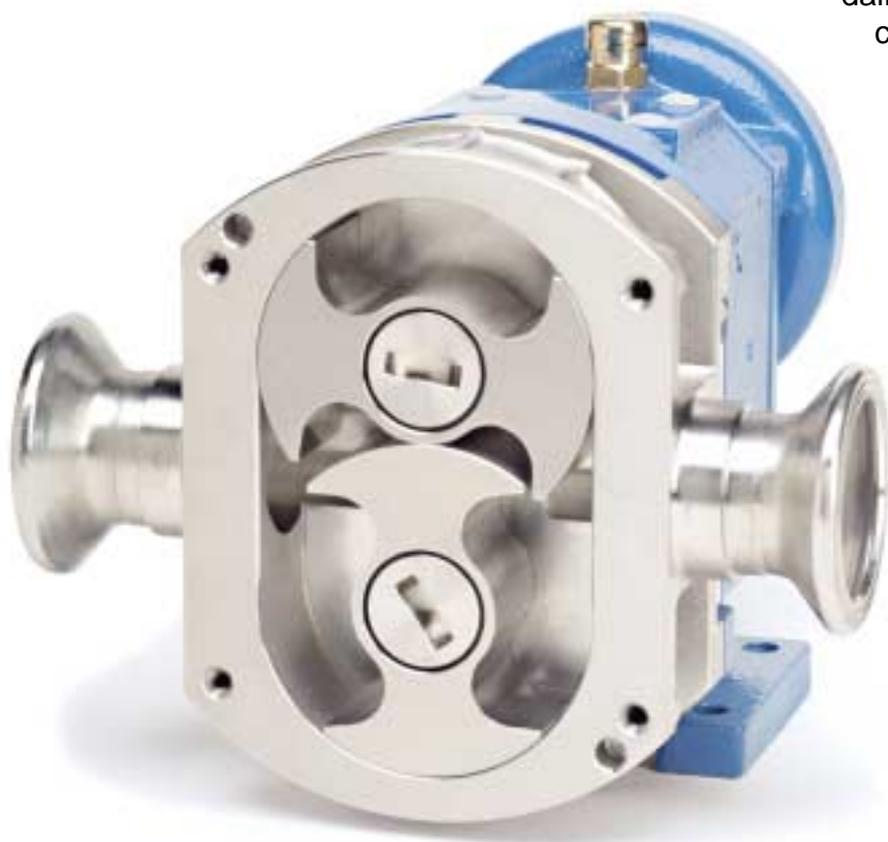
Le pompe a lobi di questa serie montano solo rotori bilobo ad aspo, in acciaio inox AISI 316 o in lega antifrizione Acteon, che garantiscono un ottimo rendimento volumetrico e un trasferimento dolce e regolare di una moltitudine di prodotti liquidi o viscosi. I rotori bilobo ad aspo hanno grandi vani che chiudendosi solo due volte al giro, rendono queste pompe idonee al trasferimento di fluidi con parti solide in sospensione, da mm. 10 per il modello BE 115 a mm. 19 per il modello BE 440.
